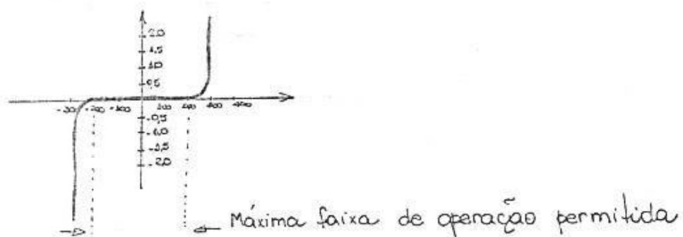
Podemos perceber pelo gráfico que a partir de um determinado valor de tensão aplicado sobre a VDR, independente da polaridade, ele começa a conduzir. A este “determinado valor de tensão” damos o nome de: Máxima tensão permitida.
